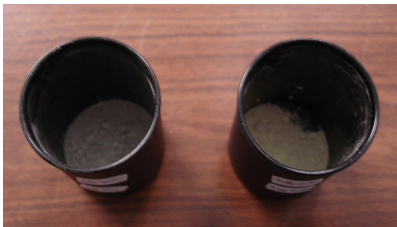
Figura 7: Foto das misturas de substâncias químicas depois da homogeneização. A esquerda a mistura do sensor Zn e à direita a mistura do sensor Cu.
