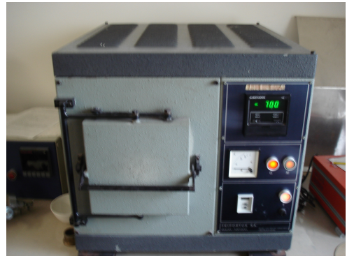
(b) Forno Friportus com controlador Siemens 7LF26.
