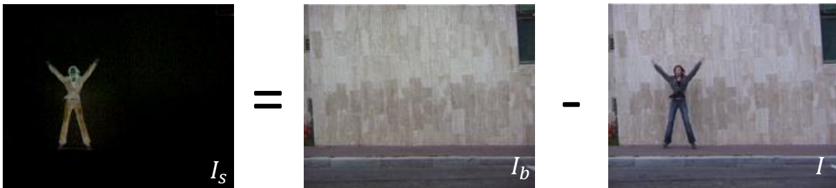
Figura 3.1: Resultado ( I_s ) da subtração de uma imagem ( I ) a uma imagem padrão ( I_b ) contendo o seu fundo estático.
