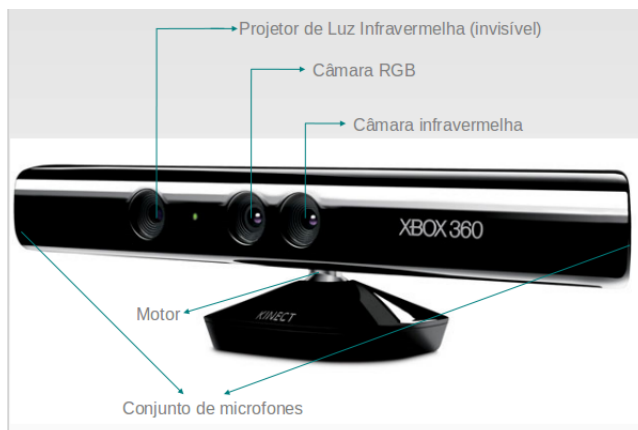
Figura 2.6 – Arquitetura do Kinect.
