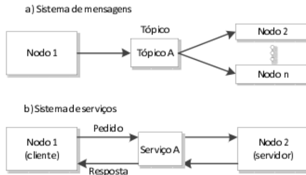
Figure 2.9 – Interface de Comunicação. a) Descrição do sistema de mensagens b) Descrição do sistema de serviços
