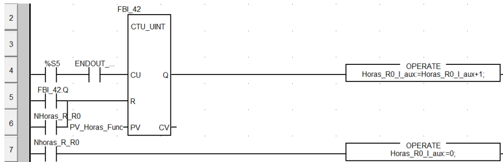
Figura 27 - Código implementado para o registo das horas de funcionamento das saídas
