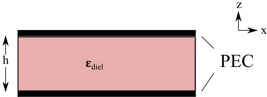
Figura 3.1: Guia metálico rectangular descrito.
