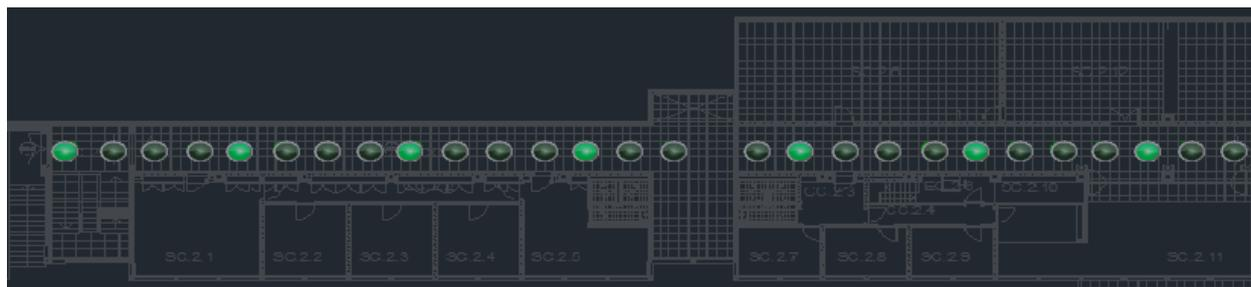
Figura 13: Controlo da iluminação com o nível de intensidade 1 ativo (zona 2 do piso 2).
