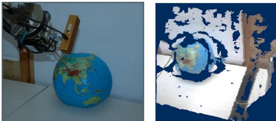
Figura 2.3 Deformação de um objeto através de um sistema robótico integrado com sensores de força e uma câmara. [7]
