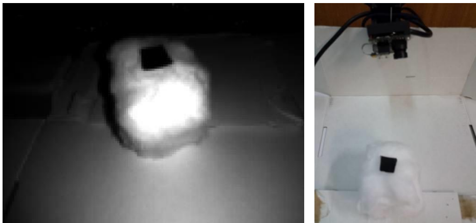
Figura 4.2 Imagem em amplitude (esquerda) e a posição da câmara em relação ao cubo de algodão (direita)
