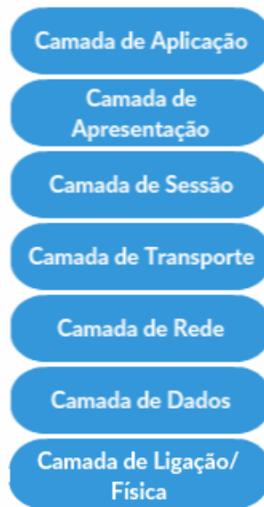
Figura 3.2: Modelo de camadas protocolar OSI.
