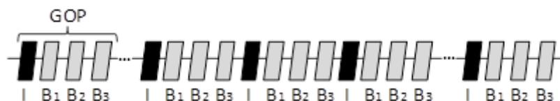
**Fig. 2.2** - Estrutura de um GOP adaptado [6].
