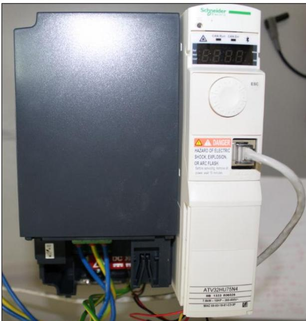
Figura 82 - Variador Eletrônico de Velocidade, Schneider ATV32HU75N4.
