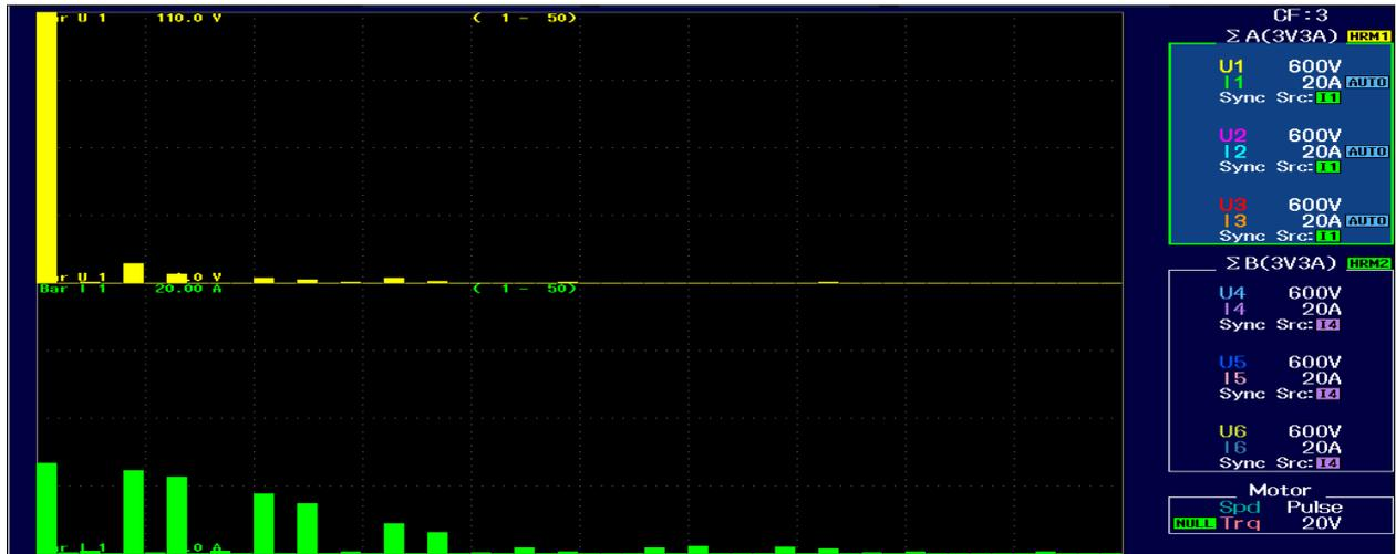
Figura 63 - Espectro harmónico da tensão e corrente na entrada do VSD. A amarelo, o espectro harmónico da tensão. A verde, o espectro harmónico da corrente
