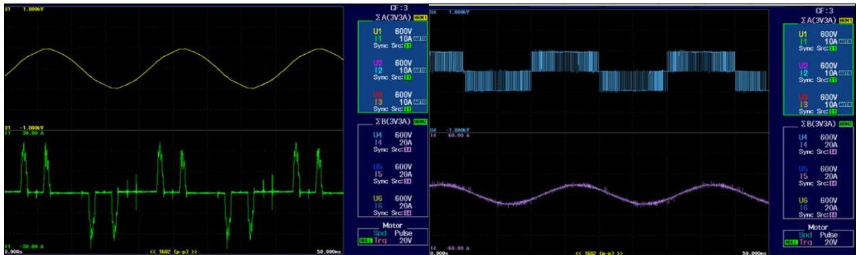
Figura 56 - Formas de onda da tensão e corrente na entrada e saída do VSD. A amarelo, tensão de entrada. A verde, corrente de entrada. A azul, tensão de saída. A roxo, corrente de saída.
