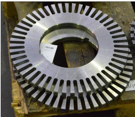
Figura 5 – Chapas que constituem o rotor bobinado.
