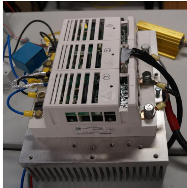
Fig. 60 - Ponte inversora trifásica.
