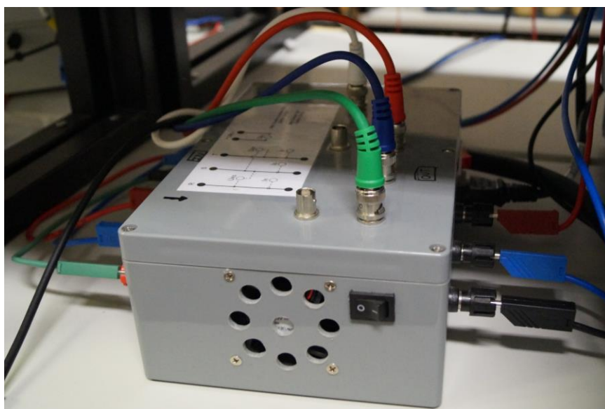
Fig. 58 - Caixa de terminais para medição e acondicionamento de sinais.
