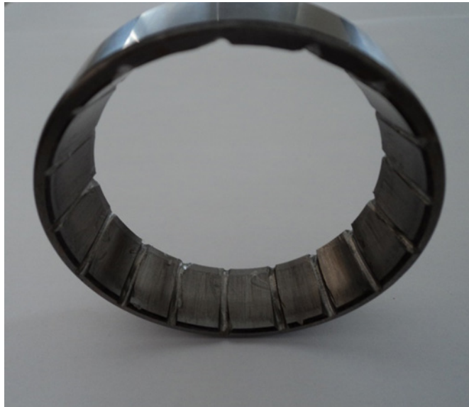
Fig. 4.4 - Rolamento cónico com estrias no anel externo.
