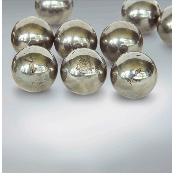
Fig. 4.2 - Defeito provocado nas esferas.
