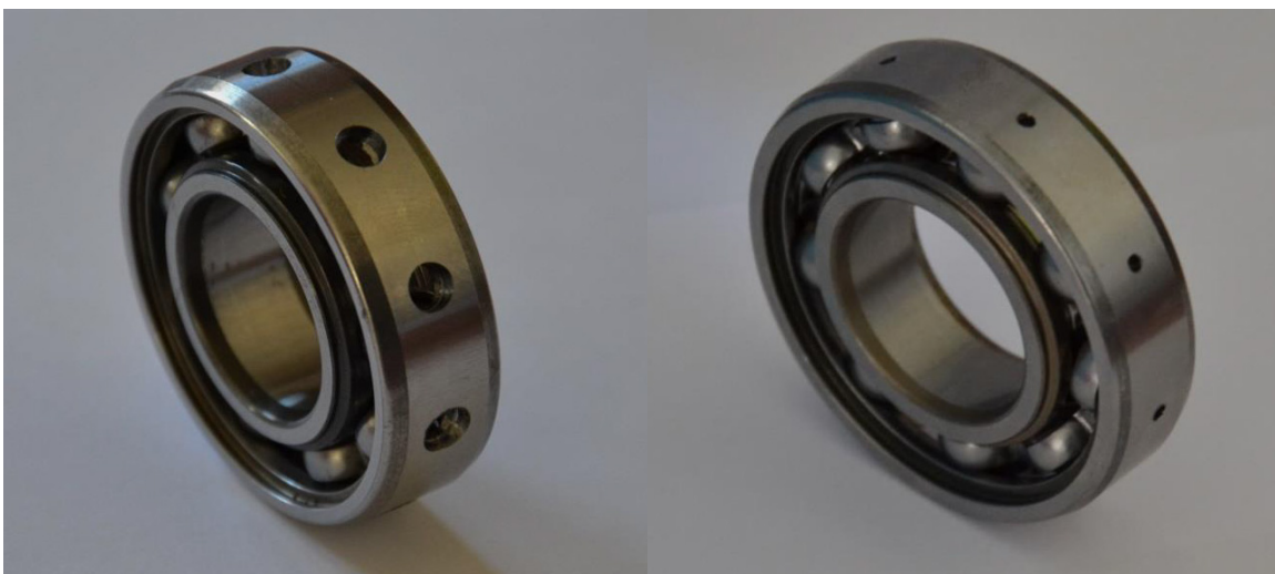
Fig. 4.3 - Rolamentos perfurados ao longo de todo o perímetro do anel externo com furos de 5 e de 2 mm.
