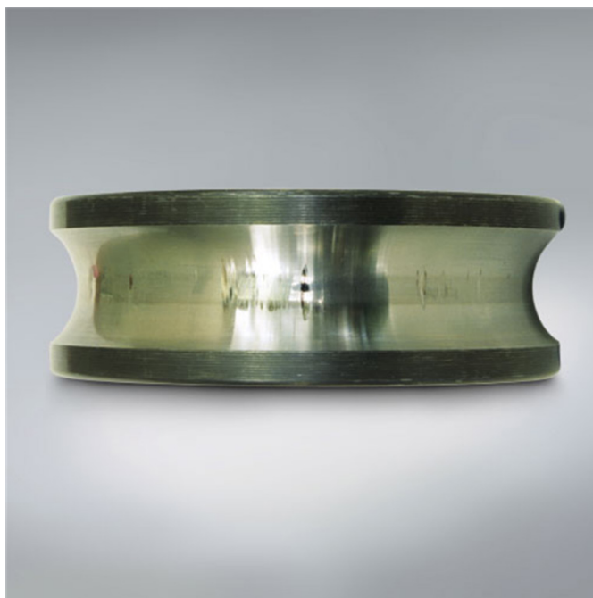
Fig. 2.2 - Fenómeno de false-brinelling 3 .
