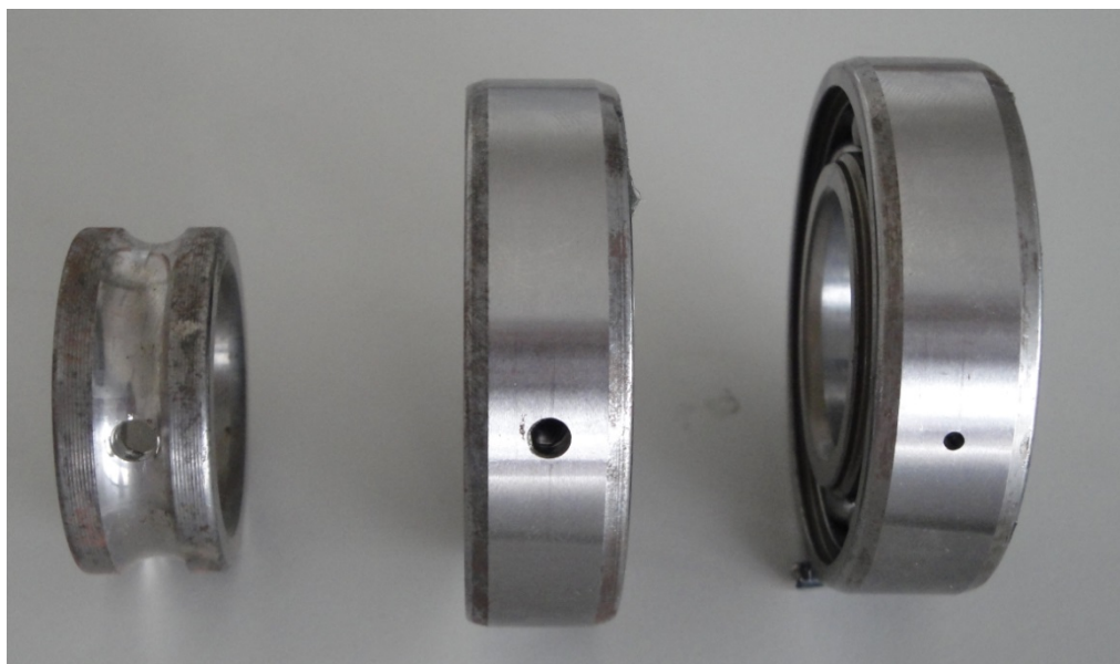
Fig. 4.1 - Rolamentos perfurados num único ponto, quer no anel interno quer no anel externo.
