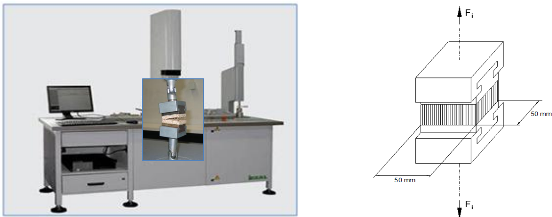
Figura 5.2 - Ensaio de resistência à tração e diagrama esquemático (adaptado IMAL-PAL ® , 2014; EN 319, 1993).
