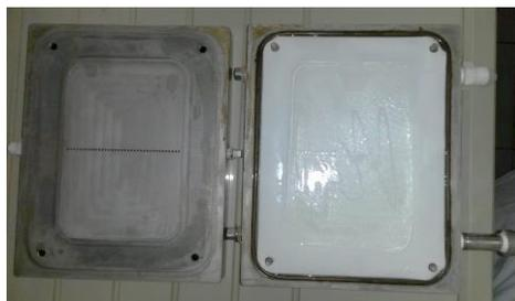
Figura 6.4 – Membrana utilizada nos ensaios de nanofiltração.
