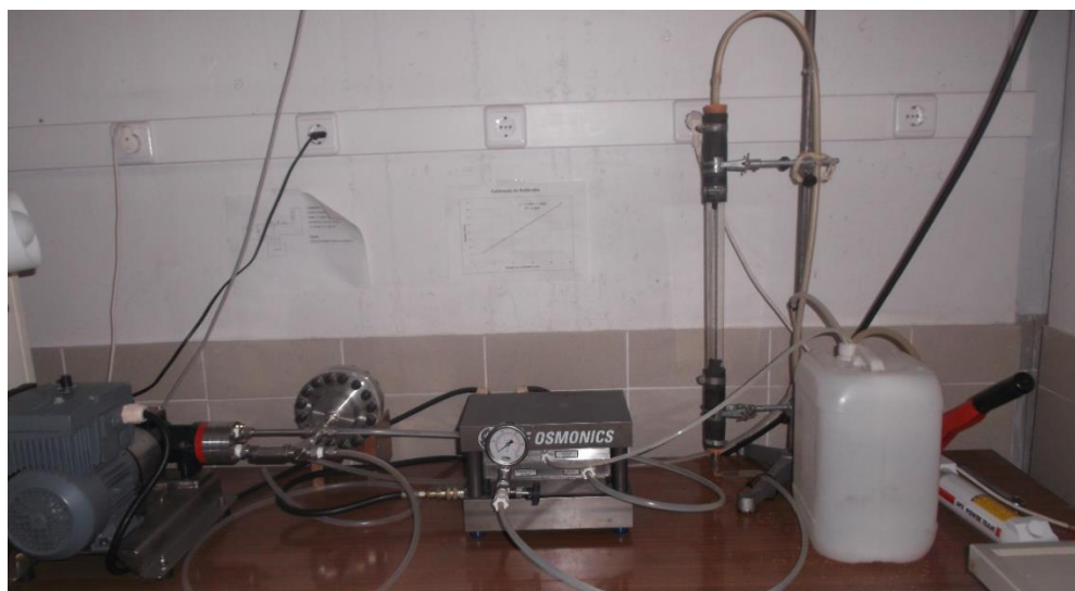
Figura 6 - Instalação laboratorial do processo de Nanofiltração.
