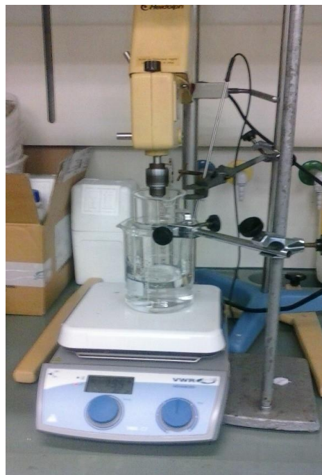
Figura 3.2. Equipamento necessário para a preparação do líquido de BTE/BTTV e dissolução da madeira.
