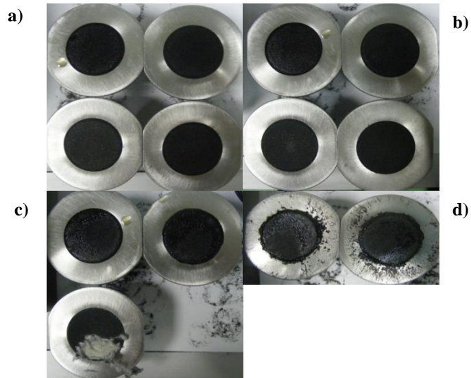
Figura 52 – a) Provetes após 100 ciclos - Nível 1; b) provetes após 500 ciclos – Nível 2; c) provetes após 2000 ciclos - Nível 3; d) provetes após 8000 ciclos - Nível 4
