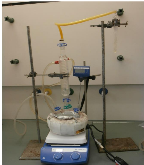
Figura 7 - Montagem experimental usada para a síntese pelo método de decomposição térmica.
