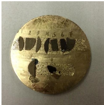
Figura 3.3 – Suporte contendo as várias amostras para a realização de SEM, após o passo de deposição de ouro.
