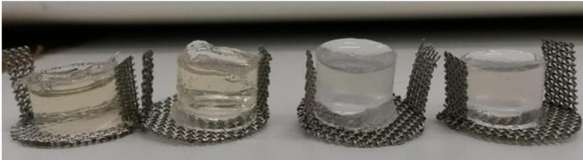
**Figura 9** – Géis de *k*-carragenano 2.5% (w/v) incorporados com naringin (à esquerda) e incorporados com nanopartículas carregadas com naringin (à direita).
