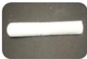
Figura 5.4 - Aspeto de um xerogel de ureia.
