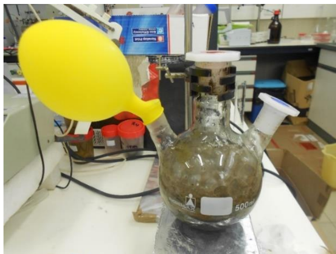
Fig. 5.12: Teste preliminar para a estimativa do tempo de reação e do volume de gás produzido no tratamento semi-batch em fase semissólida.
