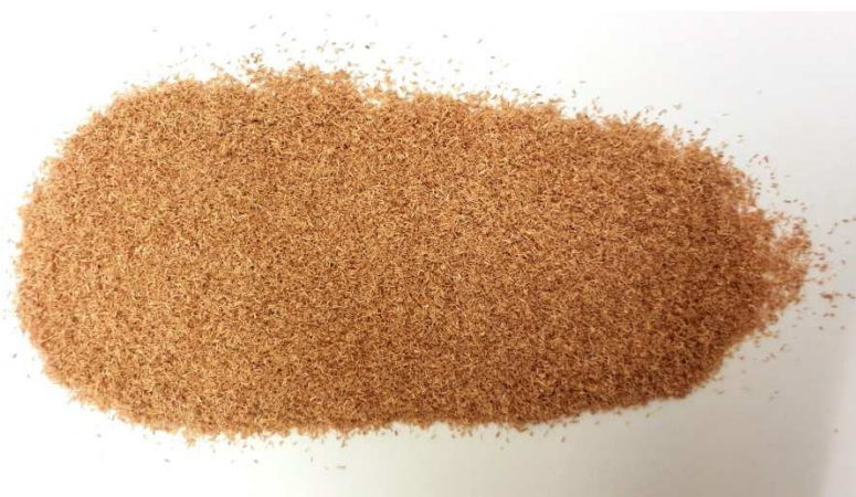
Figura 15 - Madeira moída com tamanho de partícula, 0,250-0,500 mm.
