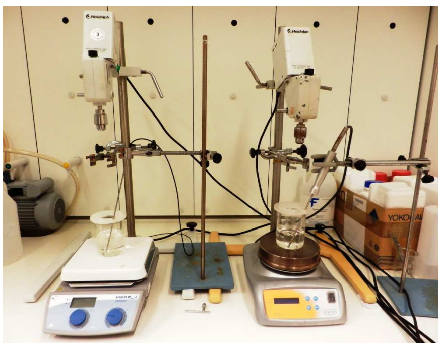
Figura 22 - Montagem dos equipamentos necessários para a dissolução da madeira.
