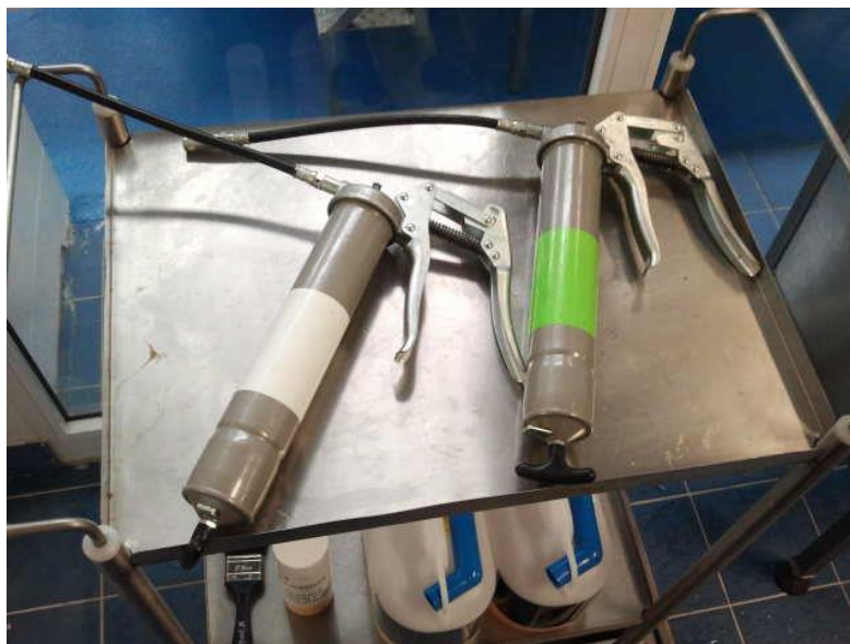
Figura 3.23. Material de lubrificação devidamente marcado com a cor do lubrificante correspondente
