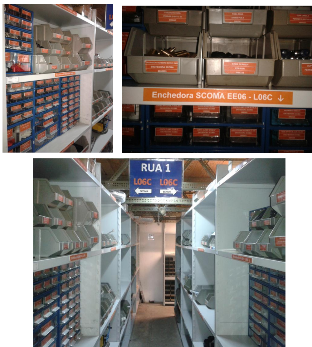
Figura 7.9. Fotos do Depois da Implementação dos 5'S no Armazém de Peças de Reserva
