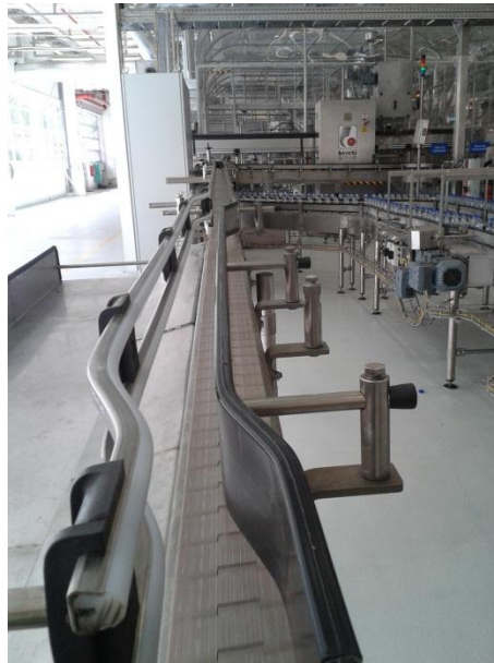
Figura 5.14. Guias Laterais Depois da Instalação de um Rejeitador.
