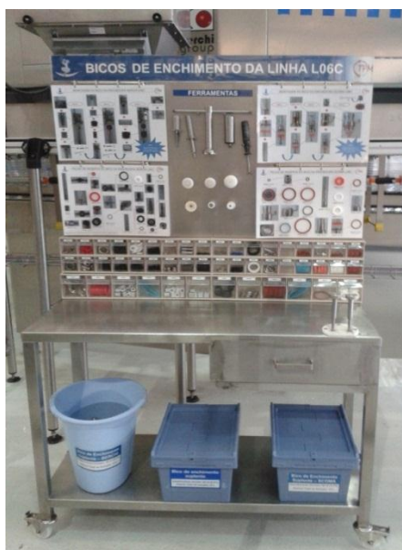
Figura 6.9. Bancada de Montagem/Desmontagem dos Bicos de Enchimento da L06C.
