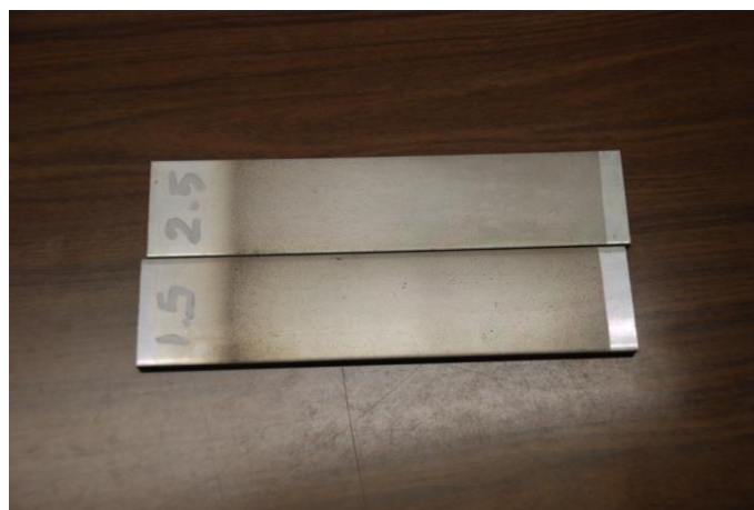
Figura 4.23. Alvos da limpeza das linhas de vapor alta pressão.
