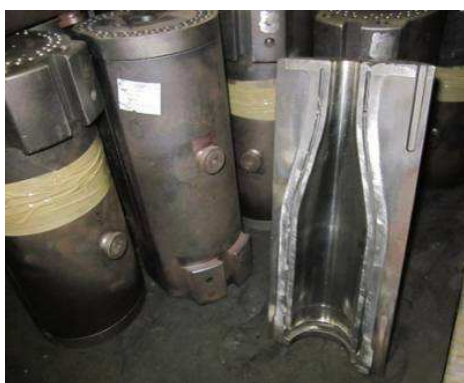
Figura 25 - Molde terminar. (Fonte – Imagem obtida nas instalações Saint Gobain Mondego)
