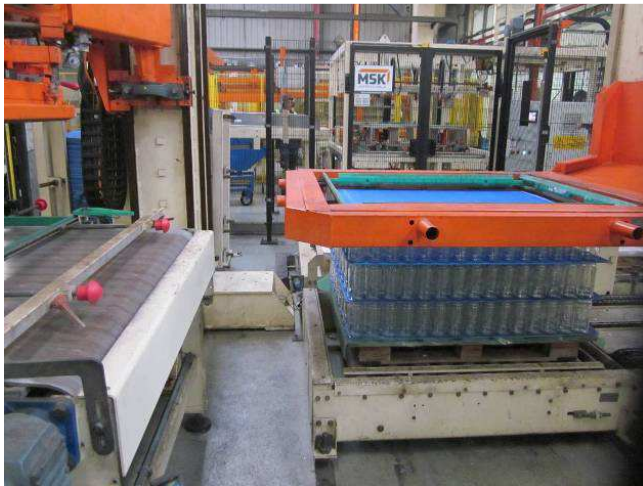
Figura 13 - Paletizador automático. (Fonte – Imagem obtida nas instalações Saint Gobain Mondego)
