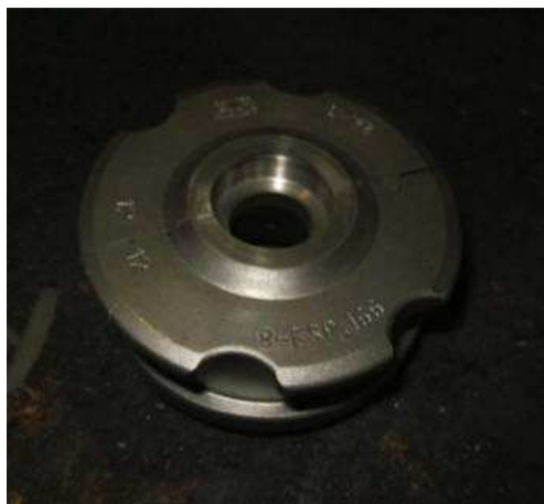
Figura 24 - Molde de boca. (Fonte – Imagem obtida nas instalações Saint Gobain Mondego)
