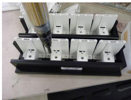
**Figura 3.8.** Posicionador auxiliar à montagem, auxilia o aparafusamento suportes de calha DIN.
