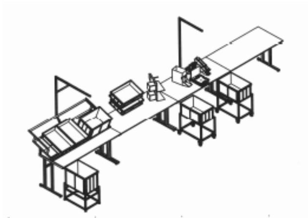
**Figura 3.9.** Representação da linha na configuração de produção de caixas de chão de 16 módulos.
