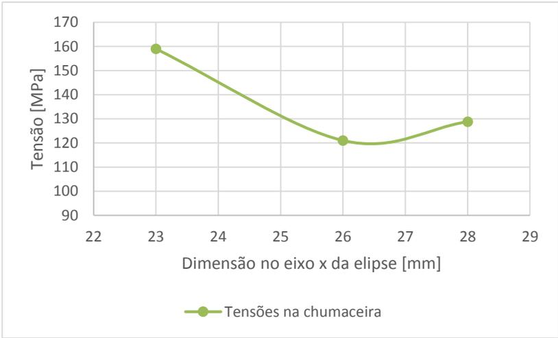
**Figura 32 - Resultados das tensões de von Mises no furo da chumaceira com a variação da dimensão no eixo x da elipse**
