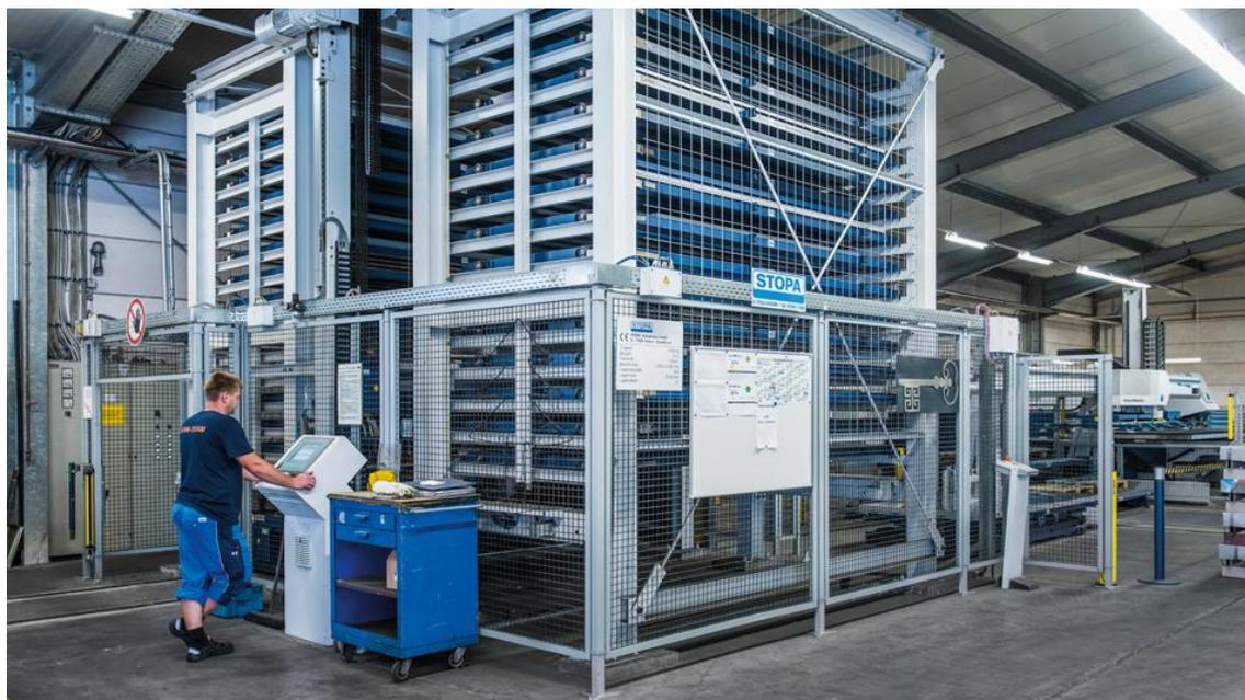
Figura 5.3. Armazém automatizado de Matéria-Prima – STOPA
