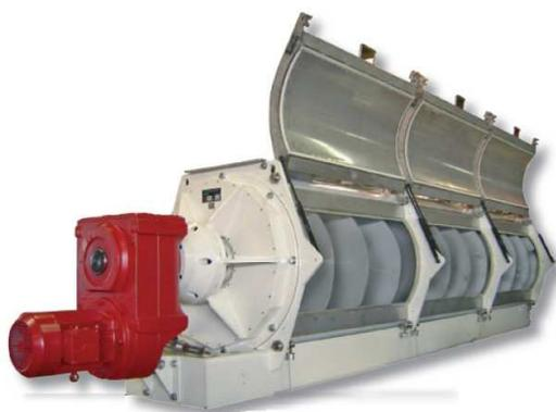
**Figura 13 - Exemplo de um condicionador.**
