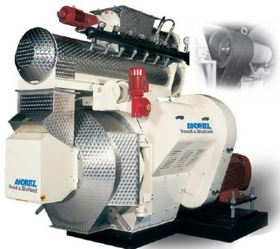
Figura 15 - Exemplo de uma granuladora.
