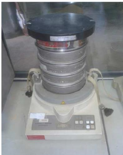
**Figura 21 - Máquina de vibração para testes de migalhas.**
