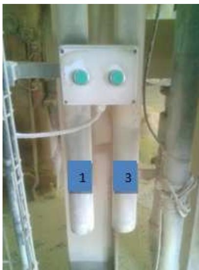
Figura 19 - Tubos onde se retiram as amostras da granuladora 1 e 3, respetivamente.
