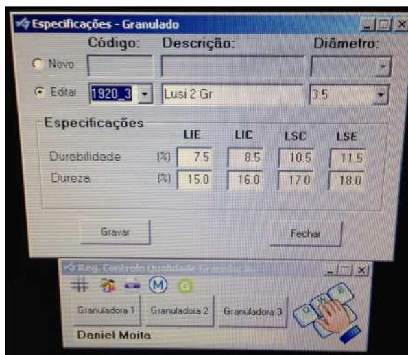
Figura 22 - Exemplo de limites de controlo e de especificação já usados para a ração "Lusi 2 Gr".
