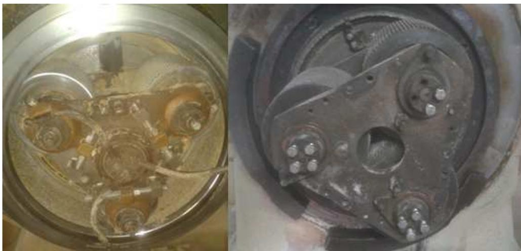
**Figura 8 - Figura que demonstra o sistema de montagem e os respectivos rolos, com (à esq.) e sem matriz (à dir.).**
