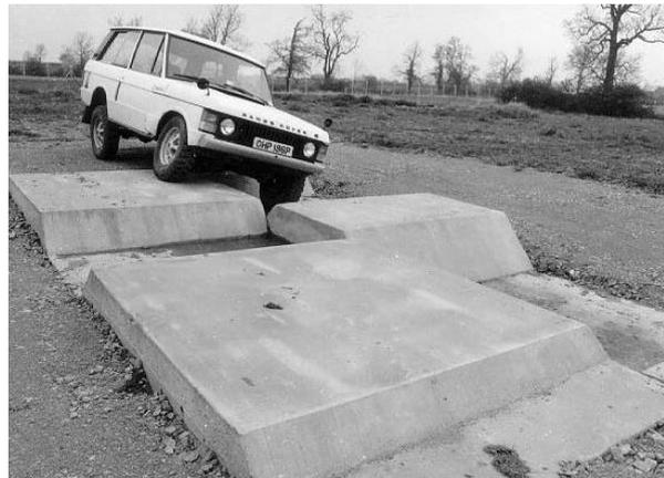
Figura 25. Veículo a passar em um ressalto, Caso de carga em torsão [Motor Vehicle Structure: Concepts and Fundamentals, J. Brown].
