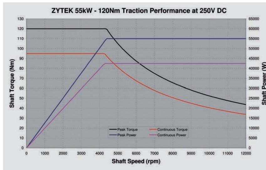
**Figura 11. Curvas características de binário e potência em função da velocidade de rotação do motor [Brochura ZYTEK IDT 120-55 Integred 55 kW Electric Engine, Zytek Automotive].**
