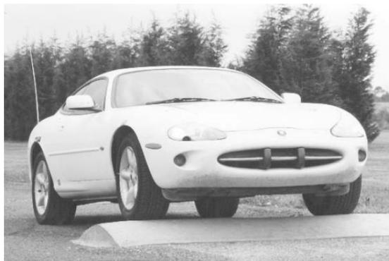
Figura 23. Veículo a passar em um ressalto, caso de carga em flexão [Motor Vehicle Structure: Concepts and Fundamentals, J. Brown].
