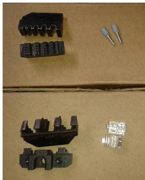
Figura 2.9. Exemplos de Matrizes para a prensa de cravação automática
