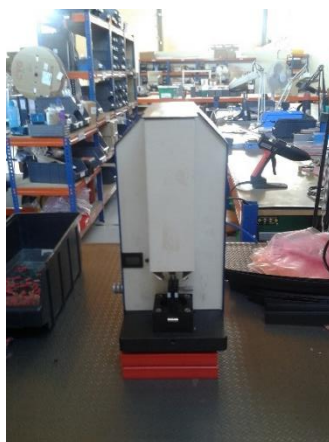
Figura 2.7. Prensa de Cravação Semi – Automática com transporte de terminal manual
