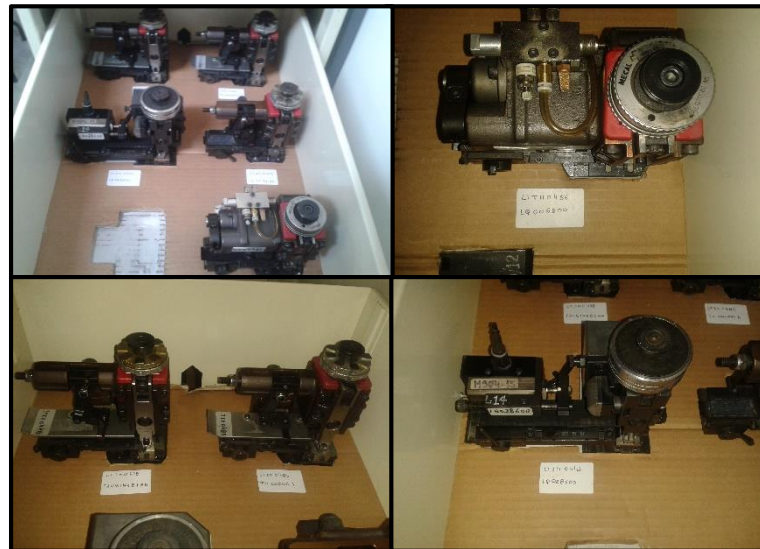
Figura 2.8. Exemplos de Aplicadores para Máquinas de Cravação
