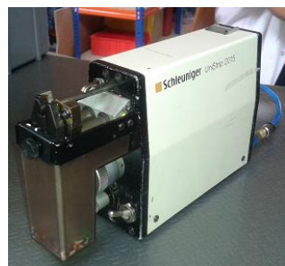
Figura 2.3. Máquina de Descarte – Schleuniger Unistrip 2015
