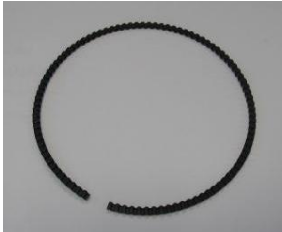
Figura 8. Espaçador com revestimento por oxidação negra.
