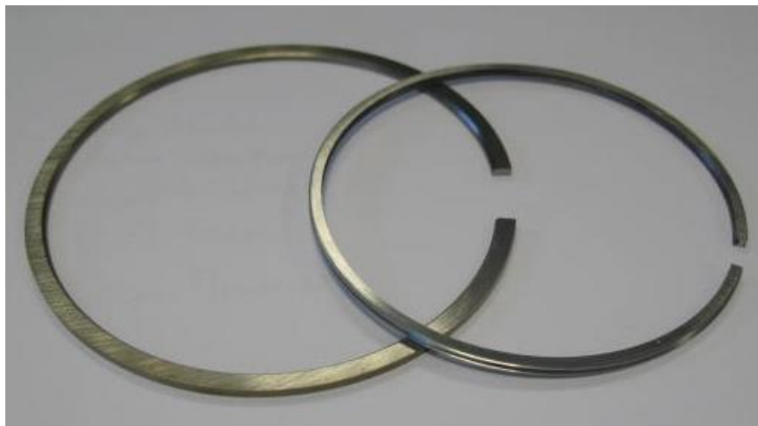
Figura 6. Exemplos de anéis decaçados na linha de fosfato.
