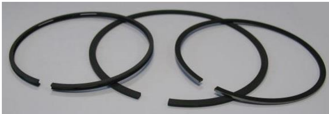
Figura 9. Anéis de ferro fundido depois de fosfatados.
