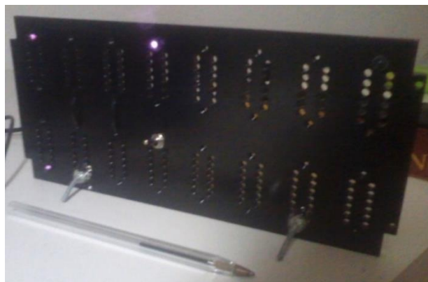
Figura 3.6. Plataforma onde estão instalados os LEDs de infravermelhos
