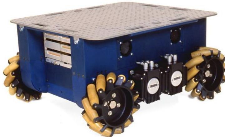
Figura 2.8. Robô Uranus , com quatro rodas Mecanum ; FONTE: (Podnar W. G., 1985)
