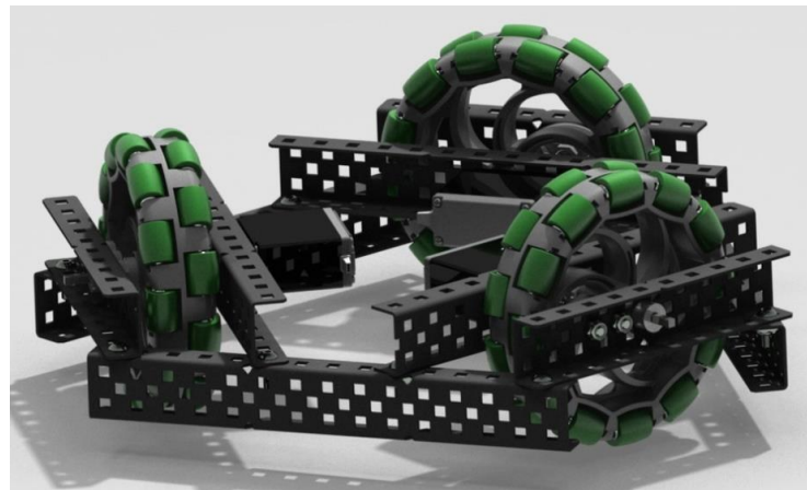
Figura 2.6. Kiwi-drive , constituído por três Omni-wheels ; FONTE: (unclejoe, 2011)
