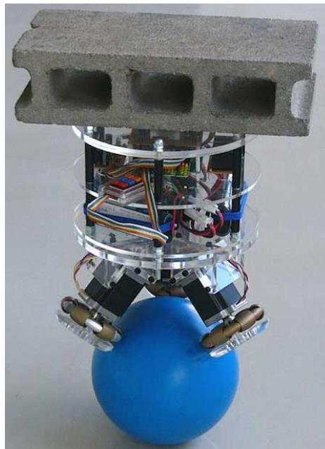
Figura 2.7. Robô BallIP suportando um tijolo de 10 quilogramas; FONTE: (Tadakuma, 2006)
