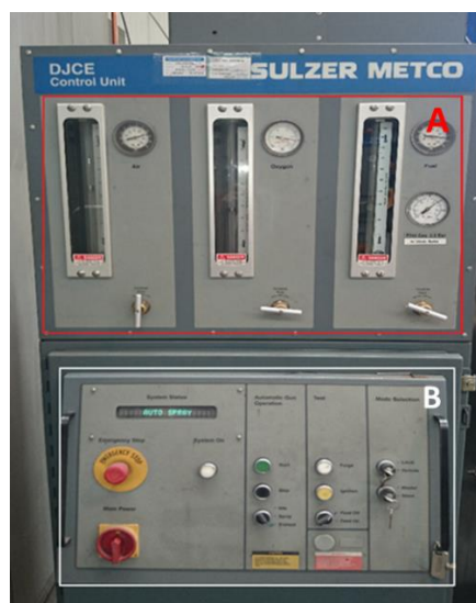
Figura 3.8. Painéis de acionamento (B) e controlo de fluxos gasosos (A) do equipamento de HVOF .
