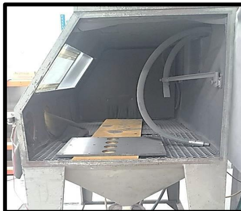
Figura 4.6. Apoio rígido das placas durante o processo de decapagem.
