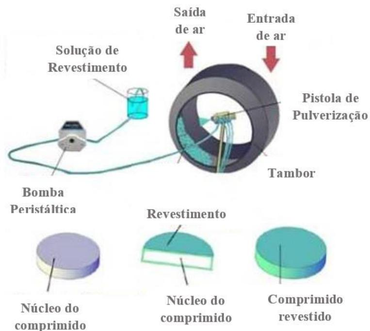
Figura 5.2. Funcionamento do sistema de revestimento.
