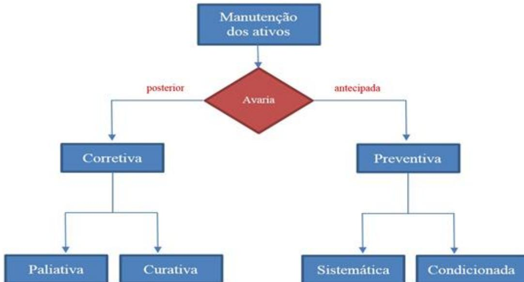
Figura 3.1. Diagrama de manutenção de equipamentos ou bens.
