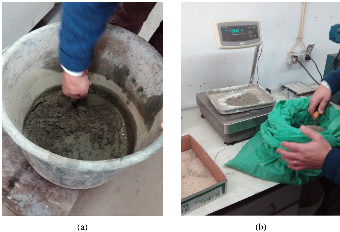
Figura 3.7. Equipamentos utilizados: (a) Balde e colher para misturar a argamassa; (b) Balança para pesagem dos constituintes.
