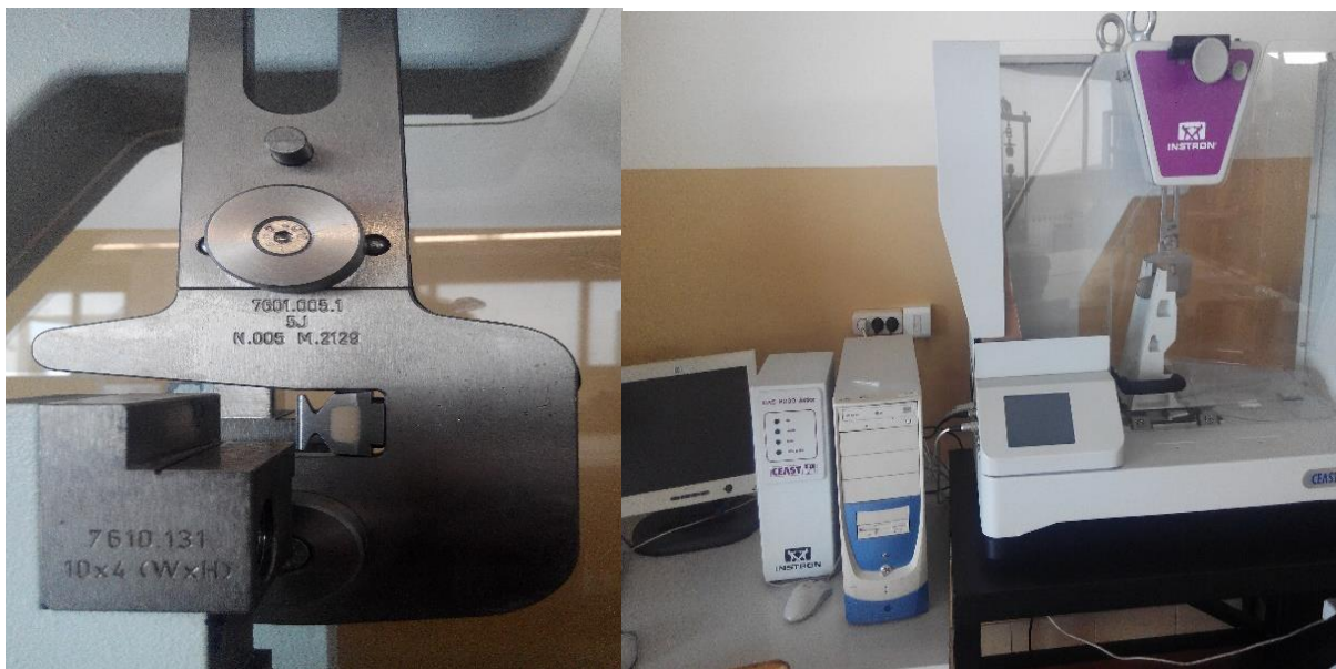
Figura 3.13- (a) Martelo utilizado no equipamento; (b) Equipamento Do Ensaio de Charpy .
