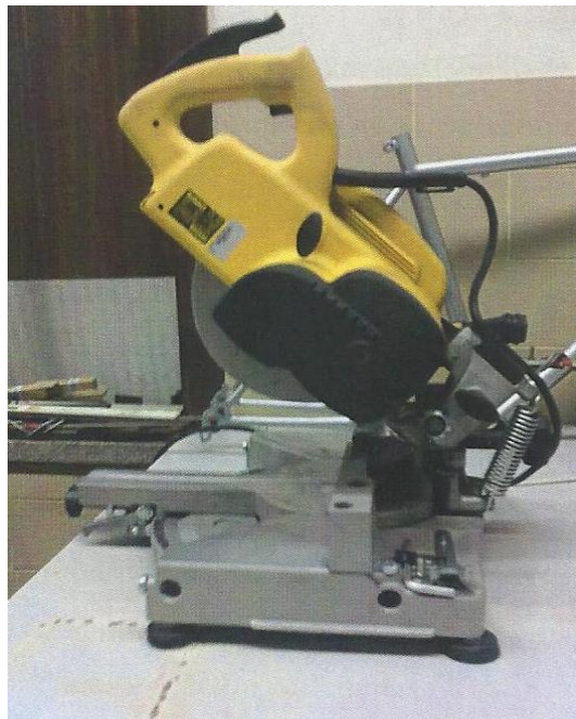
Figura 3.2. Serra elétrica utilizada para corte das placas de vidro/ epóxico.
