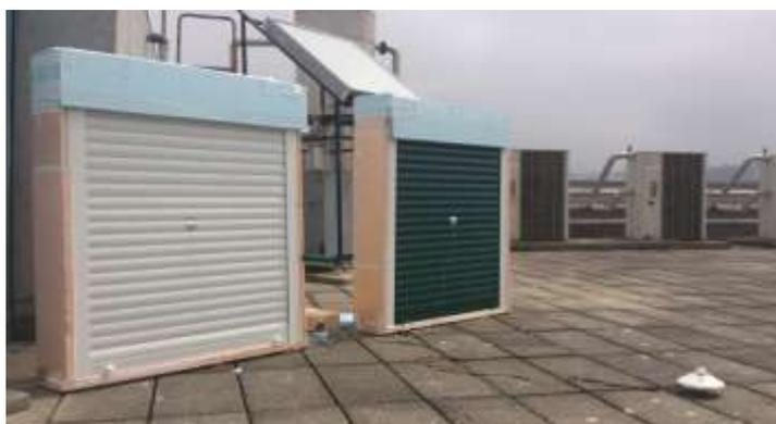
**Figura C.5 – Disposição dos modelos experimentais e do solarímetro no terraço da LAI.**
