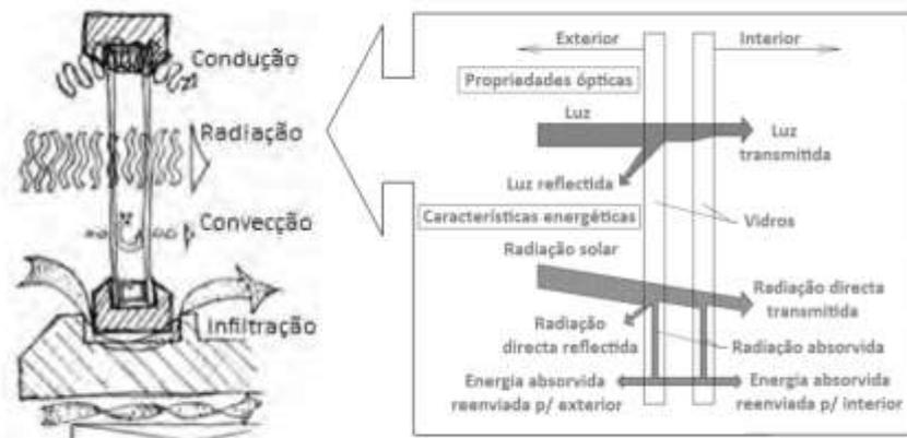
Figura 2.3 – Modos de transferência de calor num vão envidraçados .[2]
