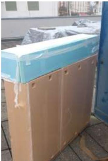
**Figura C.6 – Alteração na face posterior do modelo para reduzir a carga térmica no seu interior.**
