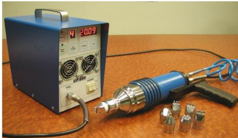
Figura 2.7. Equipamento básico para a aplicação do ultrasonic peening [13].
