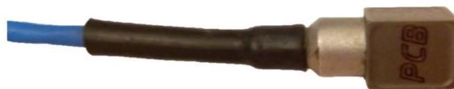
**Figura 3.5** – Acelerómetro piezoelétrico triaxial utilizado para quantificação das acelerações inerentes às vibrações induzidas.
