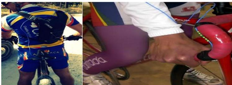
Figura 3.7 – Exemplos de instrumentação da bicicleta. À esquerda, VCI em ciclismo de piso exterior; À direita, VMB em ciclismo de pista.
