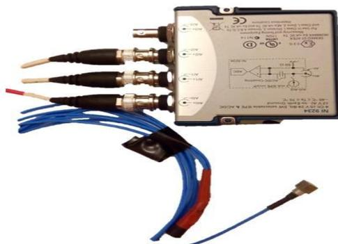
**Figura 3.4** - Módulo de aquisição e condicionamento de sinal da *National Instruments*® NI 9234 com acelerómetro acoplado.
