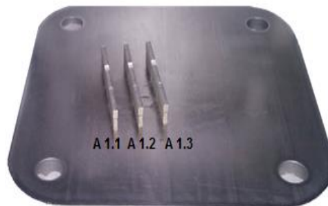
Figura 3.4. Provetes produzidos pela SLM 125 HL da SLM Solutions GmbH.
