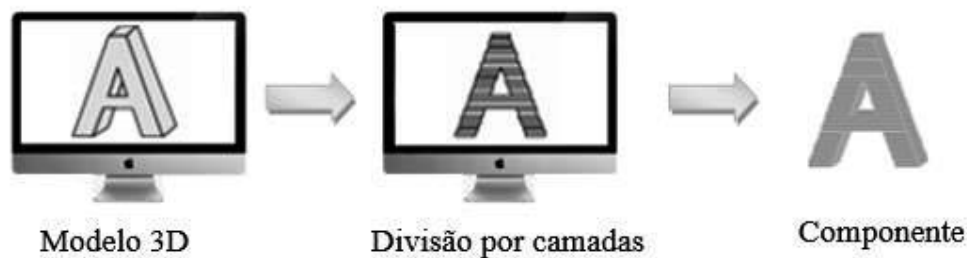
Figura 1.3. Esquemática dos principais passos dos processos aditivos.
