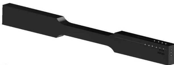
Figura 2.6. Ilustração das zonas onde a dureza foi medida.
