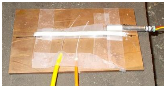
Figura 3.6- Disposição das fibras no cordão detonante no ensaio de comparação das qua fibras de PMMA à esquerda e a fibra óptica de sílica à direita.
