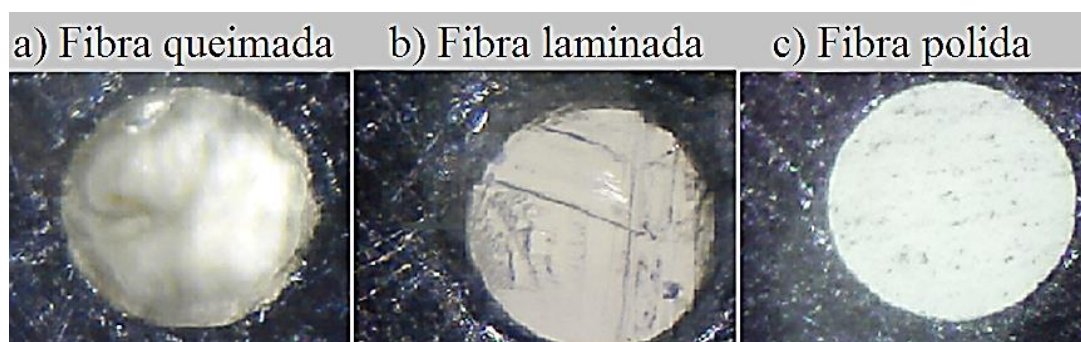
Figura 3.4-Imagens da secção da fibra óptica retiradas para a ampliação de 350x depois dos diferentes processos de fabrico dos conectores.
