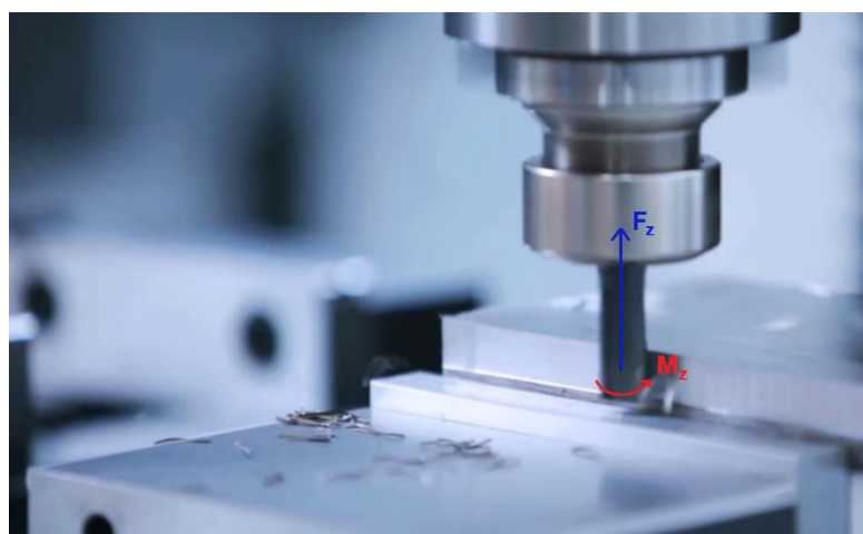
Figura 1.2. Processo de fresagem de topo [adaptado de https://www.youtube.com/user/GlacernMachineTools ].
