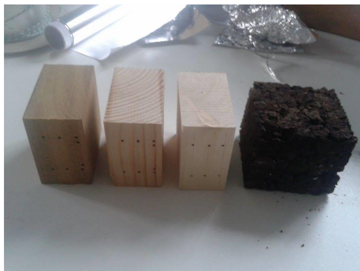
Figura 3.2 Amostras das espécies de madeira (garapa à esquerda, pinheiro bravo ao centro e pinheiro nórdico à direita) e de aglomerado de cortiça expandida.
