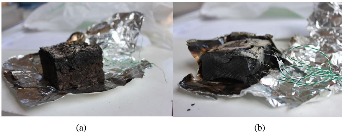
Figura 4.7 Aspeto das amostras após um ensaio em calorímetro cónico: (a) cortiça; e (b) garapa.
