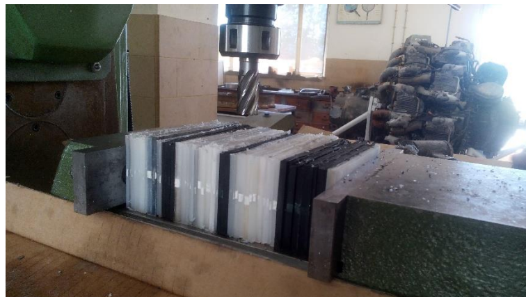
Figura 3.8. Maquinação dos provetes para ensaio de resistência residual
