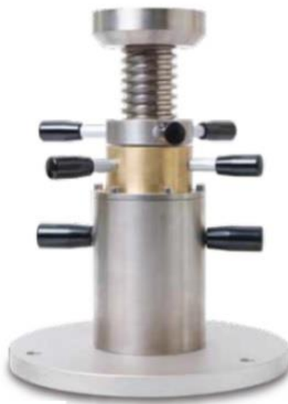
Figura 3.4. Sistema de ajuste de altura e apoio livre do provete
