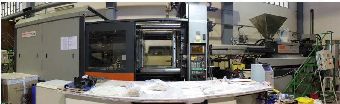
Figura 2.9. Injetora localizada nas instalações da empresa GECO
