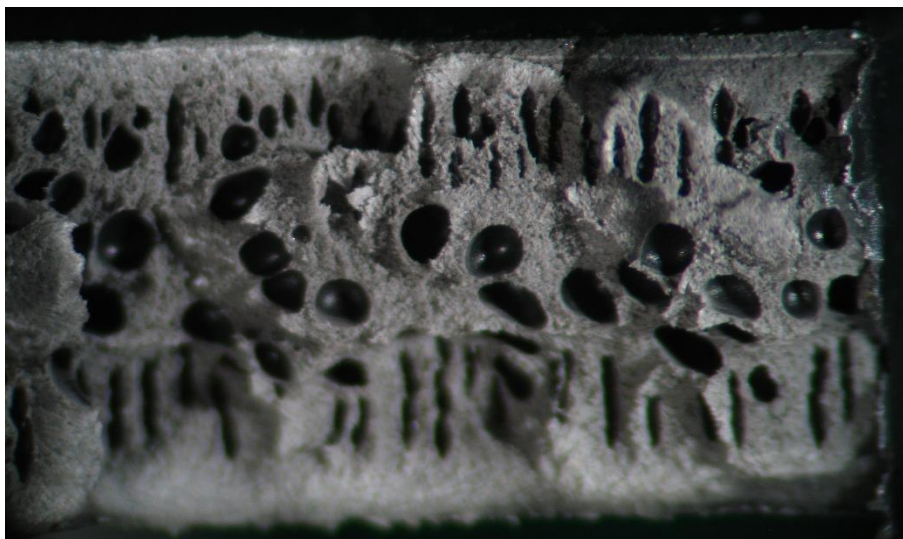
Figura 4.9. Vista de fratura de um componente fabricado em PP T20
