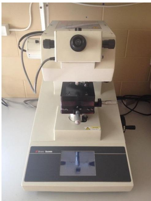
**Figura 3.10.** Durómetro Struers Duramin.
