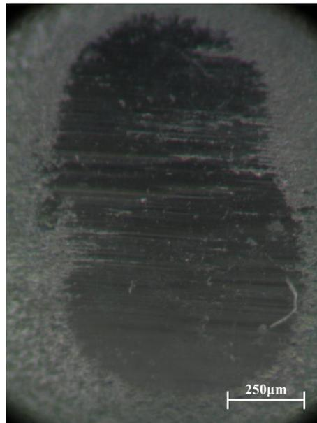
**Figura 4.21.** Marca característica obtida no antagonista num ensaio de PMMA.
