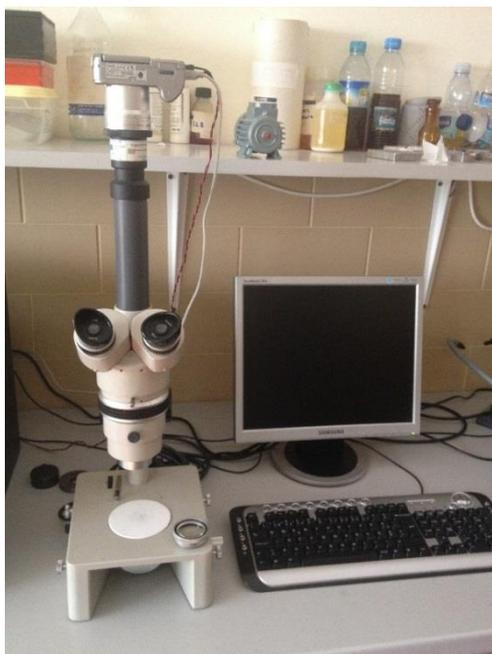
**Figura 3.9.** Microscópio ótico *Nikon Stereo Photo SMZ* e máquina fotográfica *Canon PowerShot A620*.
