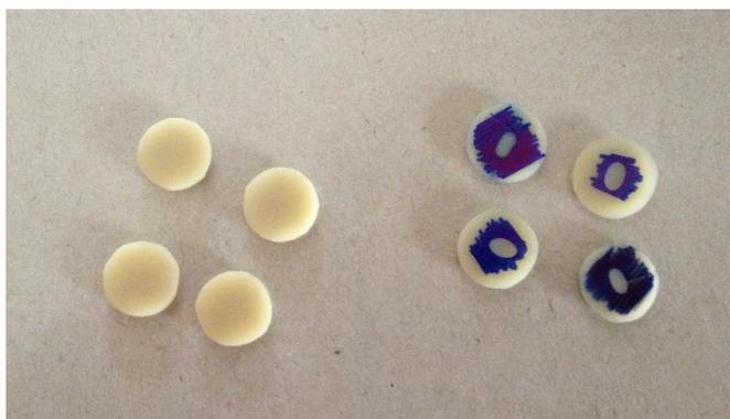
**Figura 3.1.** Provetes Synergy Compact antes e após ensaio abrasivo.
