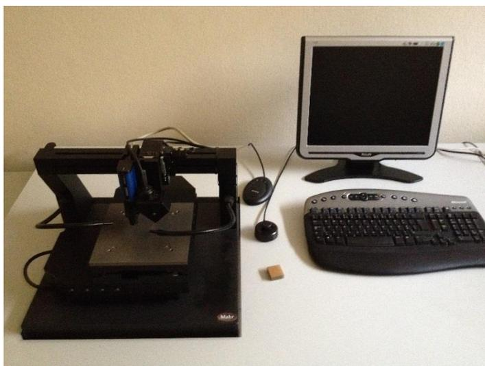
Figura 3.6. Rugosímetro laser *Rodenstock RM600*.
