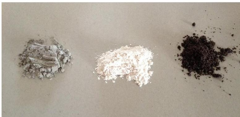
**Figura 3.3.** Abrasivos: zeoesferas, PMMA e sementes de papoila.
