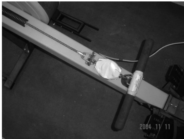
Figura 2.5. Célula de carga instalada entre a corrente e o manípulo do ergómetro (Baptista, 2005).
