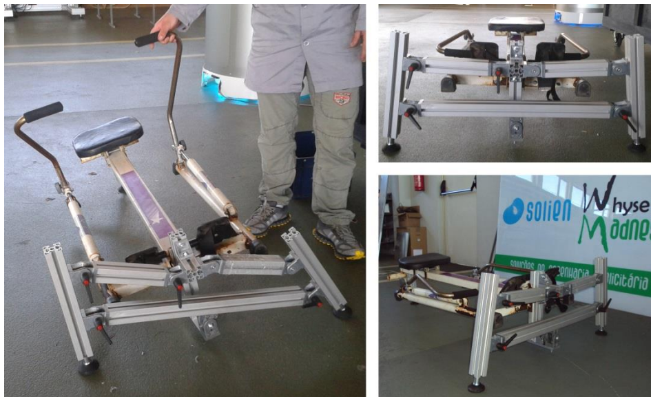
Figura 6.1. Protótipo construído para testar a inclinação do Rowtrike .
