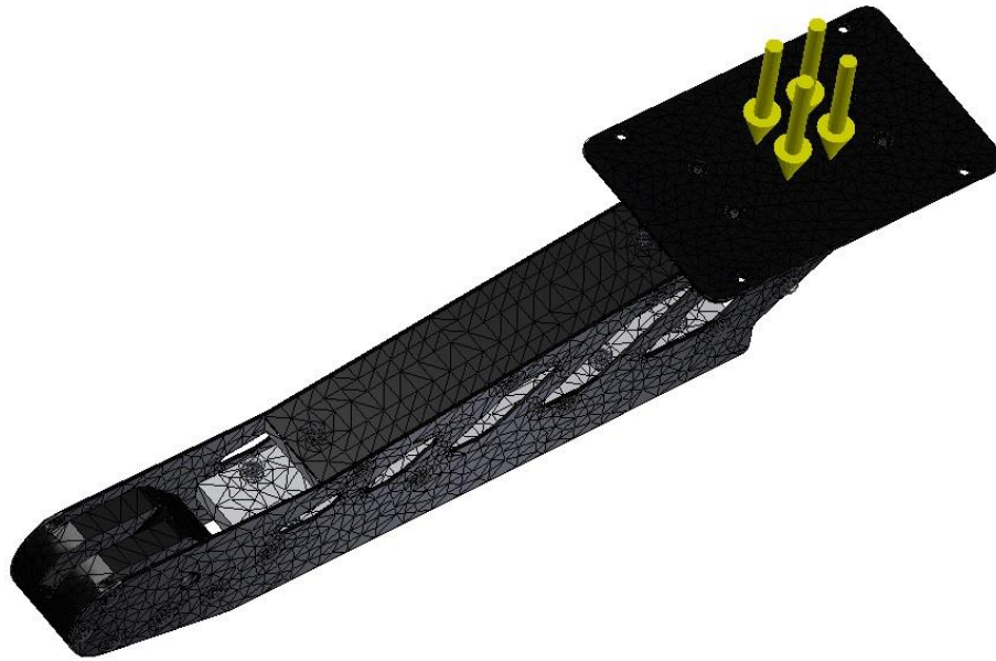
Figura 7.4. Modelo numérico da estrutura do banco.
