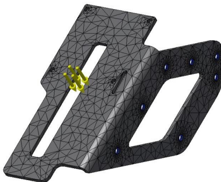
Figura 7.1. Modelo numérico da chapa de apoio de pés.
