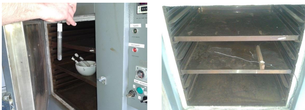
Figura E.3 - Posicionamento das amostras e do termopar no centro da estufa.
