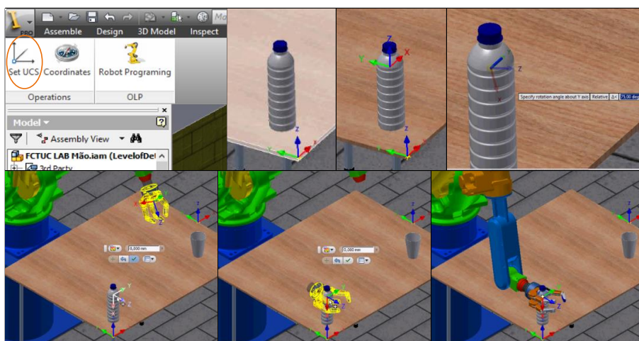
Figura 5-5 Procedimento utilizado para definição da tarefa de aproximação da frame tool à garrafa.
