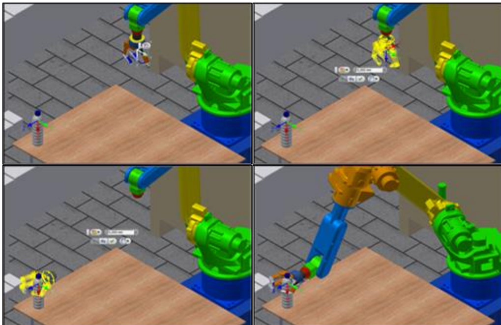
Figura 4-11 Método de movimentar o robô através de constraints
